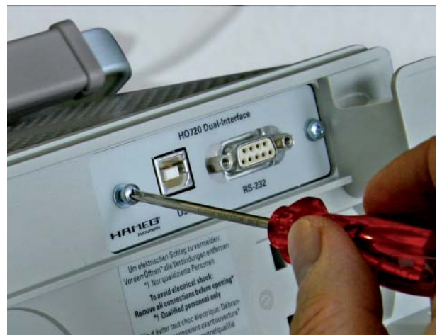
4.2.2 Befestigen Sie das Interface mit den vorher entfernten (Punkt 4.1.1) Befestigungsschrauben.
