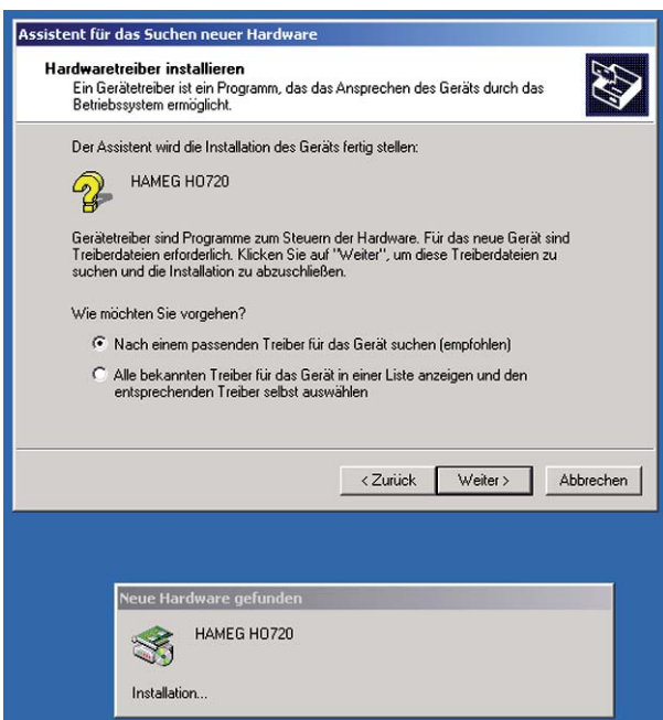
6.2.2 „Nach einem passenden Treiber für das Gerät suchen (empfohlen)“ wählen und klicken Sie anschließend auf „Weiter“.
