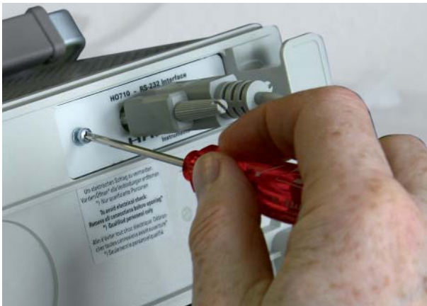
4.1.1 Entfernen Sie die beiden Befestigungsschrauben.
